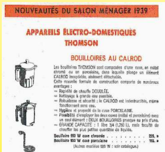
1939 Нагревательные элементы Calrod из нержавеющей стали (документ музея Ultimheat)
